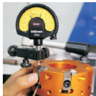
6.用测量表或对刀仪找到最高位置刀夹，将其调到目标尺寸，再将剩余刀夹依次调至目标尺寸，建议最终所有刀夹高度公差在 \pm 2\mu\text{m} 内。
