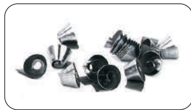
合适的中心刀片断屑
