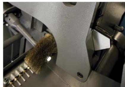
Щётка с механическим приводом для очистки ленточного полотна интенсивно удаляет стружку с пильного полотна. Это увеличивает срок службы полотна и сохраняет производительность процесса резания
