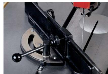
Фиксатор заготовки с угловым упором опционное оборудование
