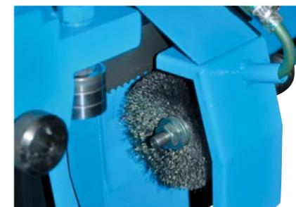
Щётка с механическим приводом для очистки ленточного полотна
