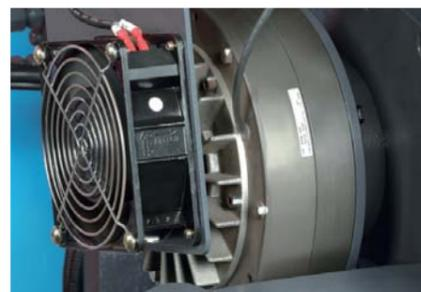
Электромагнитный порошок тормоз эффективно устраняет зазор в коробке передач при резке. Это повышает производительность процесса резания и продлевает срок службы полотна
