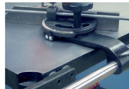
Приспособление для косога реза опционное оборудование
