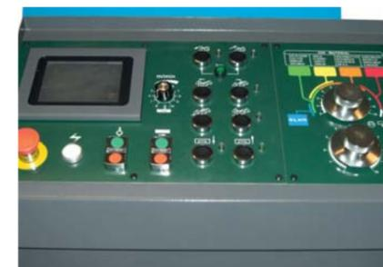
Панель управления с цветным сенсорным экраном и кнопками для ручного управления модели серии NC
