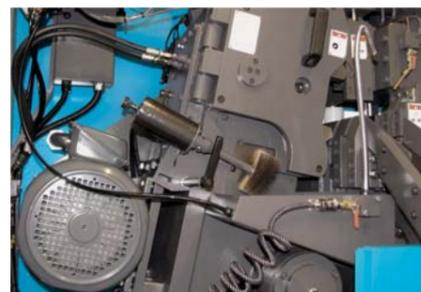
Приводной двигатель полотна
