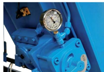
Гидравлическое натяжение пильной ленты
