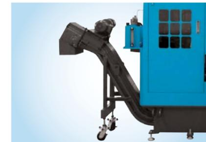
Автоматический транспортер для удаления стружки переносит стружку на высоту приблизительно в 1 метр и сбрасывает ее в установленный заказчиком резервуар-накопитель.
