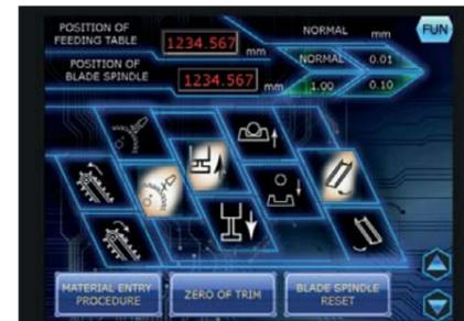
Сенсорный экран и панель управления обеспечивают легкость в эксплуатации. Информация для решения задач и устранения неисправностей выводится на экран, а данные о протекании процессов записываются в качестве справочной информации
