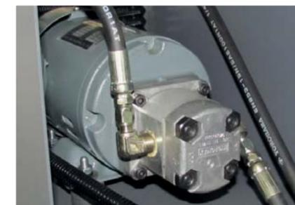
Система внешнего охлаждения коробки передач для оптимизации температуры и обеспечения бесперебойности в работе
