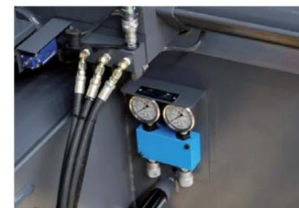
Устройство регулирования меняющегося усилия зажима тисков
