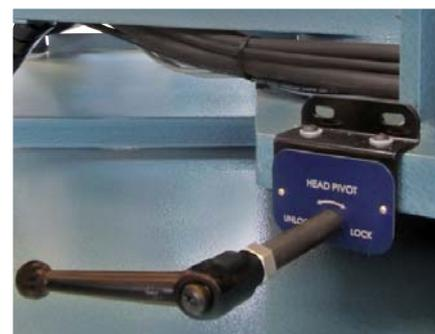
Блокировка наклона рамы
